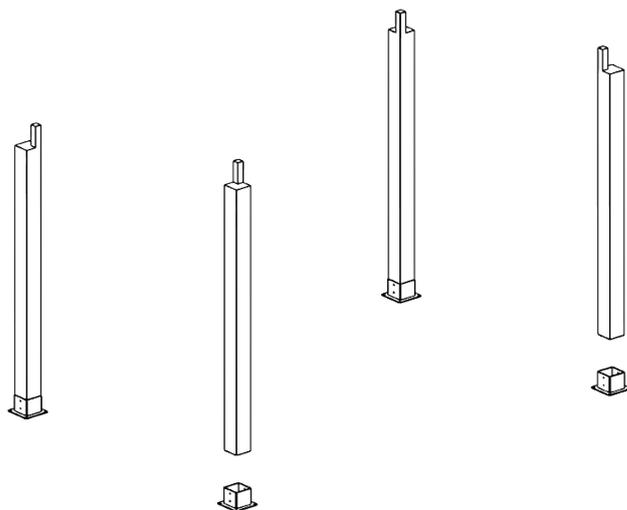
**03** Atornilla las vigas laminadas de 20 x 10 x 440 cm con los herrajes de estribos ya incorporados y atorníllalos con los tornillos 6 x 120
